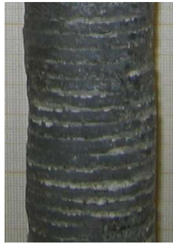
Рис. 1 – Слпок рельефа поверхности шпура на слое фиксирующего состава
